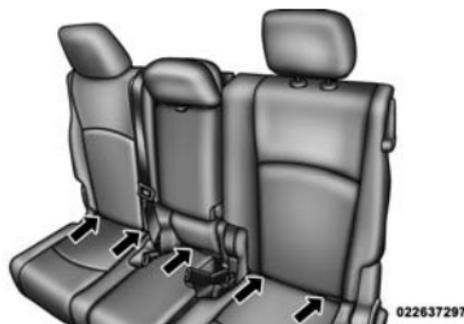
**Anclajes del sistema de anclajes inferiores y correas de sujeción para niños (LATCH)**
