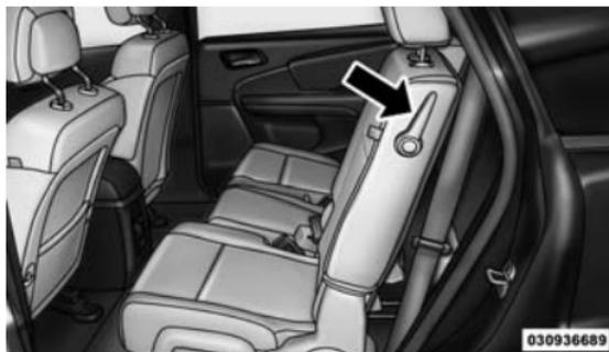
**Palanca de control de Tip 'n Slide™**
