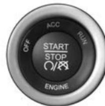
Esta función permite que el conductor haga funcionar el interruptor de encendido con la pulsación de un botón, siempre que el transmisor de acceso remoto sin llave (RKE) esté en el compartimiento del pasajero.
