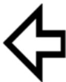
Las flechas destellan junto con el señalizador de dirección exterior cuando se activa la palanca del señalizador de dirección.
