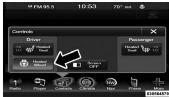
Tecla táctil Heated Steering Wheel (Volante con calefacción)
